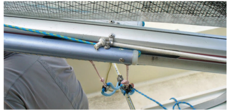
L'élastique est fixé à l'arrière du tangon et, en bleu, le lance tangon rentre dans le tangon.
