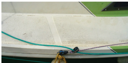
Le point de fixation du barber de spi qui est placé très en avant.
