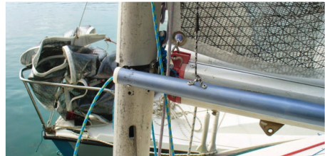
Le lance tangon sort du tangon par l'avant du tangon. On note l'absence de hale bas de tangon.
